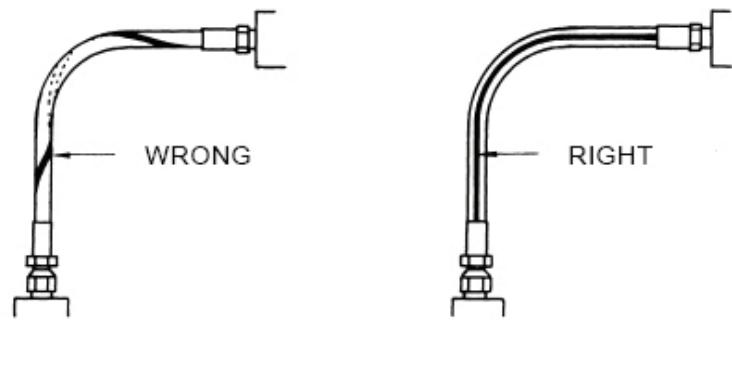
Il tubo si indebolisce se viene installato in torsione. Inoltre, la pressione pulsante in un tubo in torsione tende a sollecitare maggiormente il rinforzo ed ad allentare i raccordi. Dare all'insieme una forma tale in modo che i movimenti della macchina producano una curvatura invece che una torsione.
