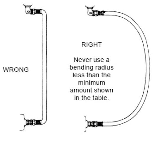
Il tubo deve uscire dal raccordo in posizione retta senza carichi trasversali. non si deve superare il raggio minimo di curvatura al fine di evitare pieghe nel tubo e conseguente riduzione del flusso.
