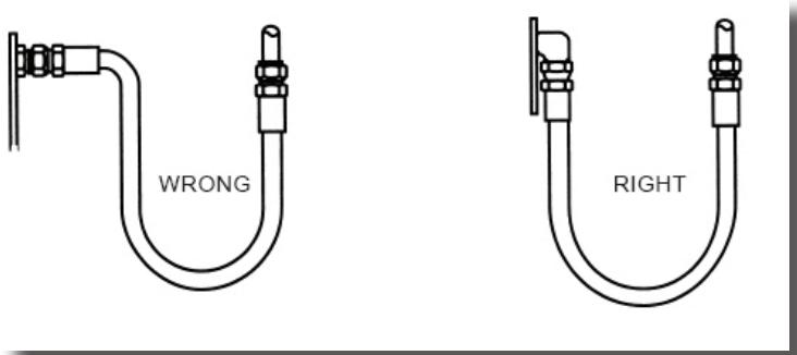
Quando il raggio di curvatura scende al di sotto del minimo, occorre impiegare i raccordi angolari per evitare pieghe acute del tubo.
